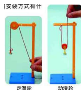
图 2 教材中的定滑轮和动滑轮实验
